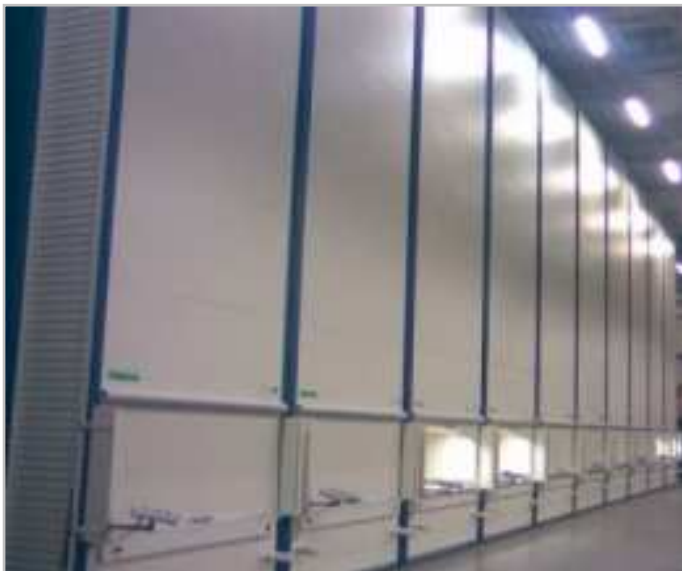
System 11 regałów automatycznych Lean-Lift o wysokości 8,8m
